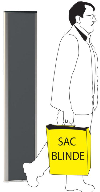
**Dans le cas d'une installation auprès de portes automatiques, une distance minimale de 100 cm est à respecter entre les portes et les antennes.**
